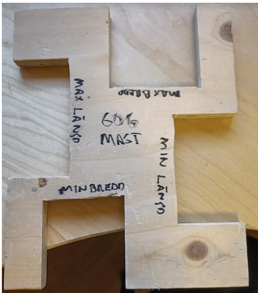
Plywoodmall för max- och min-mått längskepps och tvärskepps på mastprofil för 606
