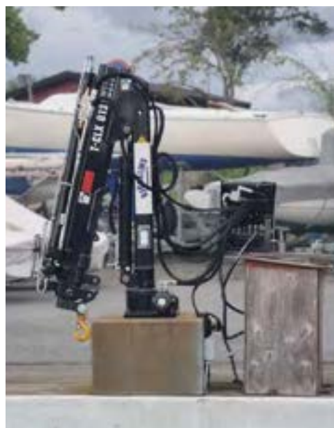
Mindre kran, lämplig som personlift (Foto: S.Ottemo)
