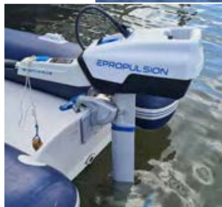
Liten elmotor, och exempel på enklare laddstolpe monterad ute på en brygga (större elmotorer kräver särskilda laddstolpar)
