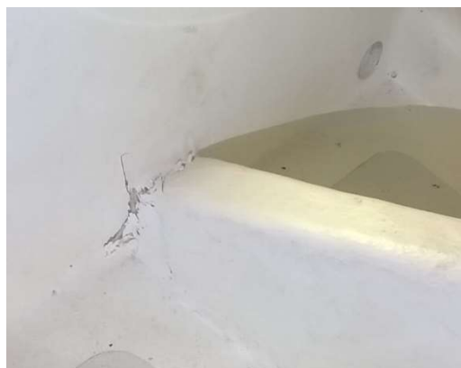
Bottenstock-kojfront efter grundsstötning
