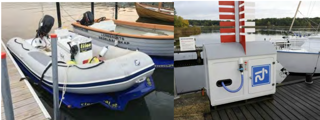
Bilder: Exempelbilder på skrovduk (t.v.) och tömningsstation (t.h)
