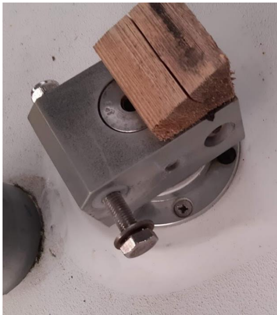
Övre roderlager, inga skador
