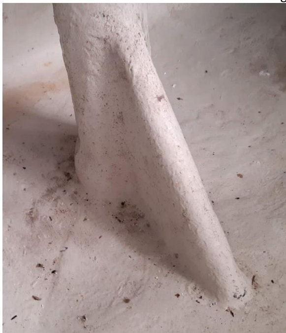
Insidan vid nedre roderlager, inga skador
