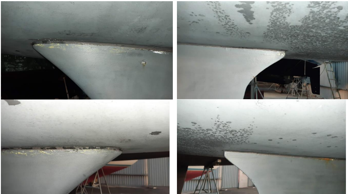
Oskadad kölinfästning där sikaflexskarven gör att färgen flagnar av
