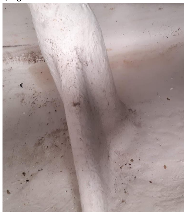
Insidan vid nedre roderlager, inga skador
