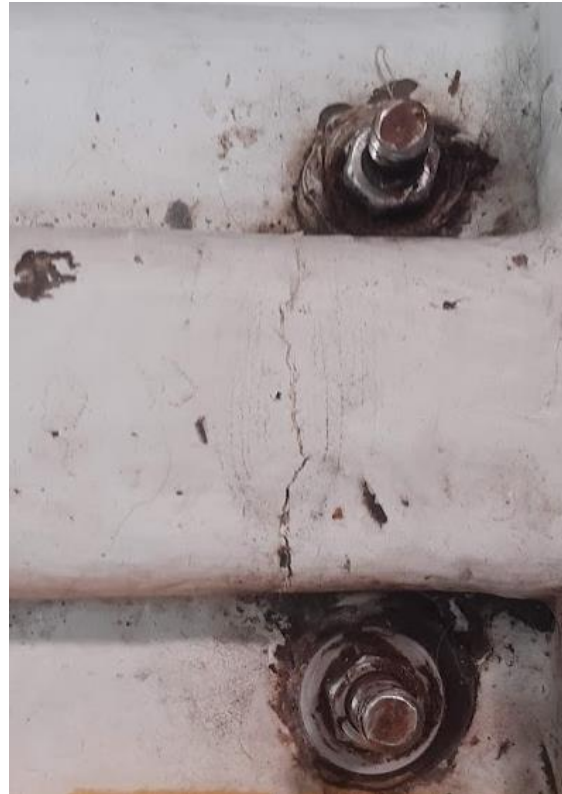
Bottenstockar med misstänkta skador
