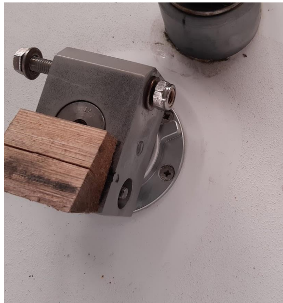
Övre roderlager, inga skador
